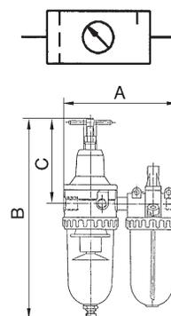
**Wartungseinheit, zweiteilig mit Polycarbonatbehälter und Tropfaufsatz aus PA**
